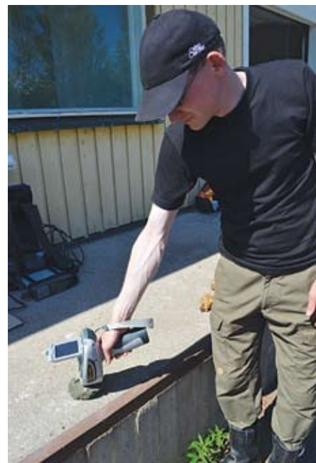
Stefan Wik demonstrerar hur den handhållna röntgenfluorescence-mätaren fungerar.
